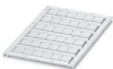
Repères pour blocs de jonction, à commander : sous forme de plaque, blanc, impression selon les indications du client, type de montage: encliquetage dans la rainure de repérage élevée, pour bloc de jonction au pas de : 10,2 mm, surface utile: 8,9 x 9,6 mm, Nombre d'étiquettes: 36
