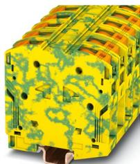
Bloc de jonction pour conducteur de protection, nombre de connexions: 2, nombre de pôles: 1, type de raccordement: Raccordement PowerTurn, 1er étage, section : 10 mm<sup>2</sup> - 70 mm<sup>2</sup>, type de montage: NS 35/15, coloris: vert/jaune
