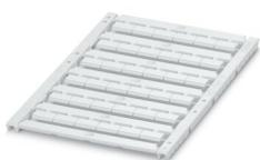
Repères pour blocs de jonction, à commander : sous forme de plaque, blanc, impression selon les indications du client, type de montage: encliquetage dans la rainure de repérage plate, pour bloc de jonction au pas de : 10,2 mm, surface utile: 9,4 x 4,7 mm, Nombre d'étiquettes: 36
