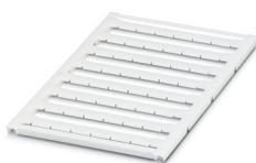
Repères pour blocs de jonction, à commander : sous forme de planche, blanc, impression selon les indications du client, type de montage: encliquetage dans la rainure de repérage plate, pour bloc de jonction au pas de : 10,2 mm, surface utile: 9,6 x 5,1 mm, Nombre d'étiquettes: 48
