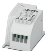
Parasurtenseurs de type 2 destiné au montage universel dans les lampes, les boîtiers de raccordement électrique, les prises d'installations, les goulottes sous allège, installation sous crépi ou directement dans l'équipement terminal. Conçu spécialement pour l'indice de protection I avec signalisation optique du défaut. Installation en câblage simple ou à dérivation. Version : 230 V AC
