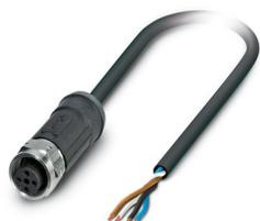
Câble pour capteurs/actionneurs, 4-pôles exempt d'halogène, extrémité libre, sur Connecteur femelle coudé M12, détrompage: A, longueur de câble: 65 m, pour applications extérieures, avec molette inox
