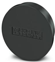
Embout de protection contre la poussière pour le connecteur de l'accumulateur d'énergie, couleur : noir RAL 9005, température ambiante pour le stockage et le transport : -40 °C ~ 70 °C, température de fonctionnement : -20 °C ~ 105 °C, sans halogène, plastiques techniques : UL94 HB, classe de protection : IP65 (avec connecteur femelle)
