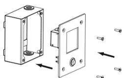
Déposer l'ensemble cadre + diffuseur à l'aide d'un tournevis adapté et de l'insert anti-vandale 98000004.
