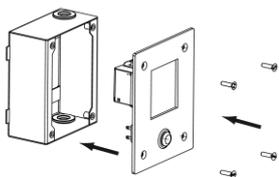
Refermer l'ensemble cadre + diffuseur à l'aide d'un tournevis adapté et de l'insert anti-vandale 98000004.
