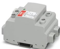
Dispositif paratonnerre / parafoudre pour systèmes à tension continue PV à 2 pôles, isolés et mis à la terre de 1500 V DC, pour montage sur rail DIN, avec contact de télésignalisation, éléments de protection avec contrôle de la température, affichage de l'état sur le module.
