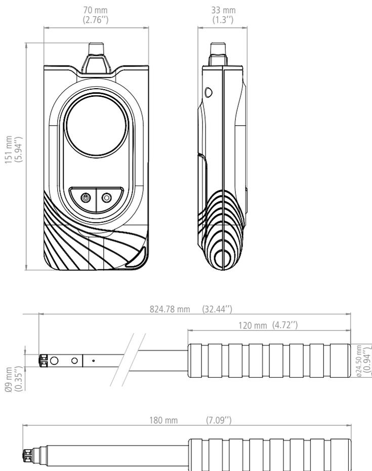
**i** La sonde télescopique est graduée de 0 à 70 cm (0 à 27 in). Le point de départ de la graduation est situé au niveau de l'élément sensible pour la vitesse d'air.
