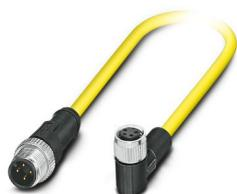
Câble pour capteurs/actionneurs, 4-pôles, PVC, jaune, connecteur mâle droit M12, détrompage: A, sur Connecteur femelle coudé M8, longueur de câble: 0,5 m
