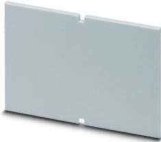
Paroi latérale à utiliser avec les demi-coques de boîtiers de dimension 125 x 87 mm ; épaisseur de paroi : 2 mm ; hauteur totale du boîtier : 67 mm ; matériau : aluminium
