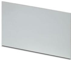
Boîtier pour profilé extrudé, Plaque avant du profilé de base, coloris: couleurs aluminium, largeur: 101,8 mm, longueur: 42,5 mm, profondeur: 2 mm, recommandé pour les éléments latéraux UM-ALU 4-..COVER AL
