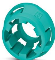
Douille de fixation pour raccordement vissé de boîtier M12 avec fonction de compensation des tolérances pour éléments de contacts de douilles M12 compatibles CMS.
