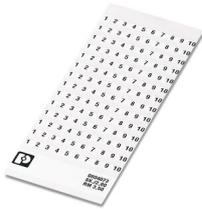
Carte de marquage, blanc, repéré, longitudinal: numérotation continue 1 ... 10, 11 ... 20, etc. jusqu'à 91 ... 99, type de montage: collage, pour bloc de jonction au pas de : 3,5 mm, surface utile: 3,5 x 2,8 mm
