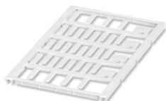
Repère pour conducteur, Planche, blanc, vierge, repérable avec : BLUEMARK ID COLOR, BLUEMARK ID, BLUEMARK CLED, PLOTMARK, CMS-P1-PLOTTER, type de montage: insertion, plage de diamètre de câble: 0,6 ... 46 mm, surface utile: 15 x 4 mm, Nombre d'étiquettes: 32
