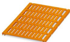
Repère pour conducteur, Planche, orange, vierge, repérable avec : TOPMARK NEO, LASER TOPMARK, BLUEMARK ID COLOR, BLUEMARK ID, BLUEMARK CLED, THERMOMARK PRIME, THERMOMARK CARD 2.0, THERMOMARK CARD, type de montage: insertion, plage de diamètre de câble: 0,6 ... 50 mm, surface utile: 15 x 4 mm, Nombre d'étiquettes: 50
