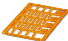
Repère pour conducteur, Planche, orange, vierge, repérable avec : BLUEMARK ID COLOR, BLUEMARK ID, BLUEMARK CLED, PLOTMARK, CMS-P1-PLOTTER, type de montage: insertion, plage de diamètre de câble: 0,6 ... 46 mm, surface utile: 15 x 4 mm, Nombre d'étiquettes: 32
