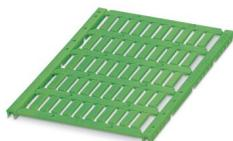
Repère pour conducteur, Planche, vert, vierge, repérable avec : TOPMARK NEO, LASER TOPMARK, BLUEMARK ID COLOR, BLUEMARK ID, BLUEMARK CLED, THERMOMARK PRIME, THERMOMARK CARD 2.0, THERMOMARK CARD, type de montage: insertion, plage de diamètre de câble: 0,6 ... 50 mm, surface utile: 15 x 4 mm, Nombre d'étiquettes: 50
