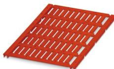
Repère pour conducteur, Planche, rouge, vierge, repérable avec : TOPMARK NEO, LASER TOPMARK, BLUEMARK ID COLOR, BLUEMARK ID, BLUEMARK CLED, THERMOMARK PRIME, THERMOMARK CARD 2.0, THERMOMARK CARD, type de montage: insertion, plage de diamètre de câble: 0,6 ... 50 mm, surface utile: 15 x 4 mm, Nombre d'étiquettes: 50
