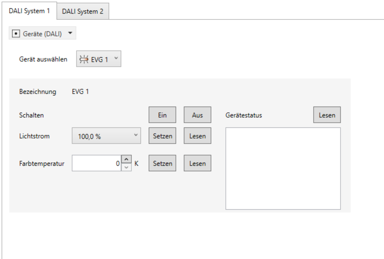
Bild 79: Beispielhafte Ansicht des Tests "Geräte (DALI)"
