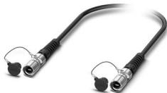
Série M17 MPO avec assemblage de connecteurs à fibre optique préconfectionné : connecteur mâle-connecteur mâle 12 pôles, fibre de verre multimode G62.5/125  $\mu\text{m}$  OM1 avec raccordement vissé, longueur du câble fibre optique : 180 m, indice de protection IP67 après insertion, installation fixe dans des goulottes, des goulottes souterraines et des tubes de protection de câbles pour une utilisation en intérieur et en extérieur
