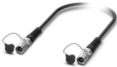
Série M17 MPO avec assemblage de connecteurs à fibre optique préconfectionné : connecteur mâle-connecteur mâle 12 pôles, fibre de verre multimode G62.5/125  $\mu\text{m}$  OM1 avec raccordement vissé, longueur du câble fibre optique : 80 m, indice de protection IP67 après insertion, installation fixe dans des goulottes, des goulottes souterraines et des tubes de protection de câbles pour une utilisation en intérieur et en extérieur
