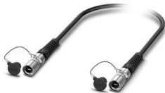
Série M17 MPO avec assemblage de connecteurs à fibre optique préconfectionné : connecteur mâle-connecteur mâle 12 pôles, fibre de verre multimode G62.5/125  $\mu\text{m}$  OM1 avec raccordement vissé, longueur du câble fibre optique : 190 m, indice de protection IP67 après insertion, installation fixe dans des goulottes, des goulottes souterraines et des tubes de protection de câbles pour une utilisation en intérieur et en extérieur
