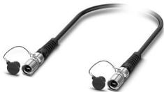
Série M17 MPO avec assemblage de connecteurs à fibre optique préconfectionné : connecteur mâle-connecteur mâle 12 pôles, fibre de verre multimode G62.5/125 µm OM1 à raccordement vissé, longueur du câble fibre optique : 50 m, indice de protection IP67 après insertion, installation fixe dans des goulottes, des goulottes souterraines et des tubes de protection de câbles pour une utilisation en intérieur et en extérieur
