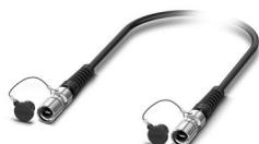
Série M17 MPO avec assemblage de connecteurs à fibre optique préconfectionné : connecteur mâle-connecteur mâle 12 pôles, fibre de verre multimode G62.5/125 µm OM1 à raccordement vissé, longueur du câble fibre optique : 60 m, indice de protection IP67 après insertion, installation fixe dans des goulottes, des goulottes souterraines et des tubes de protection de câbles pour une utilisation en intérieur et en extérieur
