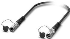
Série M17 MPO avec assemblage de connecteurs à fibre optique préconfectionné : connecteur mâle-connecteur mâle 12 pôles, fibre de verre multimode G62.5/125  $\mu\text{m}$  OM1 avec raccordement vissé, longueur du câble fibre optique : 160 m, indice de protection IP67 après insertion, installation fixe dans des goulottes, des goulottes souterraines et des tubes de protection de câbles pour une utilisation en intérieur et en extérieur
