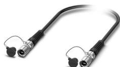
Série M17 MPO avec assemblage de connecteurs à fibre optique préconfectionné : connecteur mâle-connecteur mâle 12 pôles, fibre de verre multimode G62.5/125 µm OM1 avec raccordement vissé, longueur du câble fibre optique : 10 m, indice de protection IP67 après insertion, installation fixe dans des goulottes, des goulottes souterraines et des tubes de protection de câbles pour une utilisation en intérieur et en extérieur
