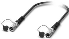
Série M17 MPO avec assemblage de connecteurs à fibre optique préconfectionné : connecteur mâle-connecteur mâle 12 pôles, fibre de verre multimode G62.5/125  $\mu\text{m}$  OM1 avec raccordement vissé, longueur du câble fibre optique : 100 m, indice de protection IP67 après insertion, installation fixe dans des goulottes, des goulottes souterraines et des tubes de protection de câbles pour une utilisation en intérieur et en extérieur
