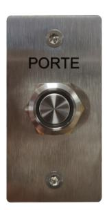
Poussoir lumineux NO/NF. Fermeture par 2 vis, antivandales. Façade en acier inox, gravée "PORTE". Dimensions façade ( $L \times H$ ):  $35 \times 60 \, \text{mm}$ .
