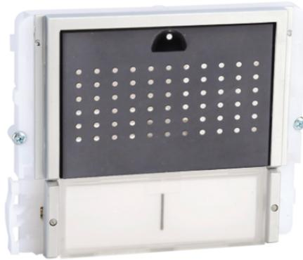
Module prédisposé pour HP-micro audio, avec façade finition acier inox. Étiquettes porte-noms avec éclairage à led au choix : bleu, blanc et Off. À compléter avec HP-micro correspondant au système de câblage utilisé. Dimensions : 112 x 89,5 x 32 mm.
