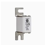
**Cartouche fusible, grande vitesse, 315 A, AC 900 V, 125 kA, size 00, 30 x 47 x 98 mm, aR, DIN, IEC, indicateur de fusion simple**
