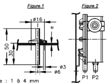
Veillez à passer le tube flexible dans l'un des presse-étoupe fournis avec le coffret de relayage, afin de conserver le degré d'étanchéité IP du coffret.
