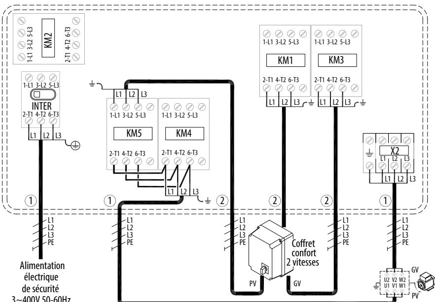
Nota : seuls les raccordements à effectuer sont indiqués sur ce schéma. Les autres câblages réalisés d'usine ne sont pas représentés et ne doivent en aucun cas être modifiés.
