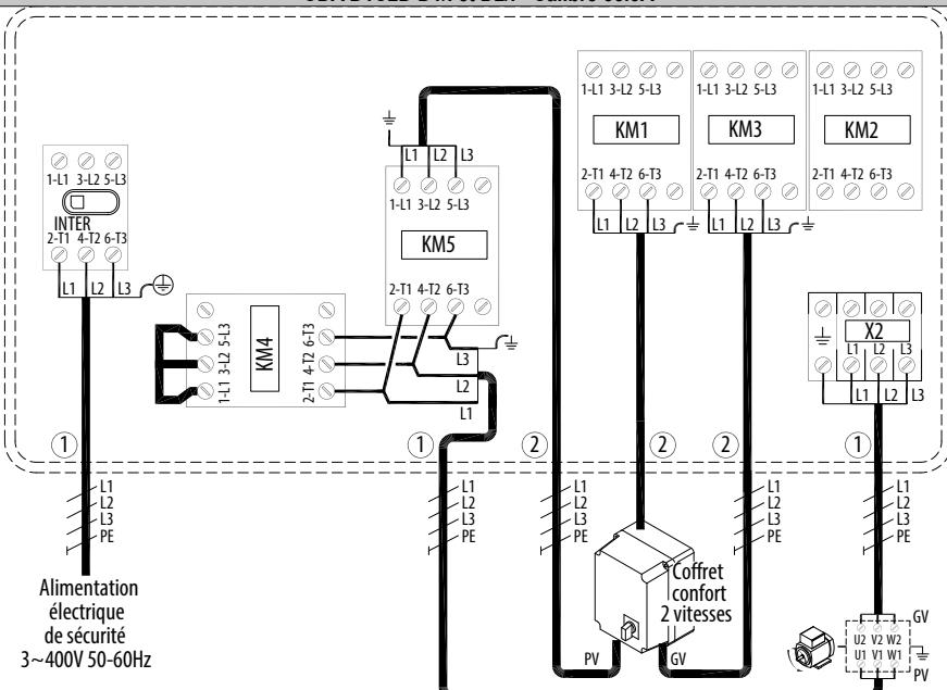
(1) câble protégé au feu ; (2) câble conventionnel Nota : seuls les raccordements à effectuer sont indiqués sur ce schéma. Les autres câblages réalisés d'usine ne sont pas représentés et ne doivent en aucun cas être modifiés.
