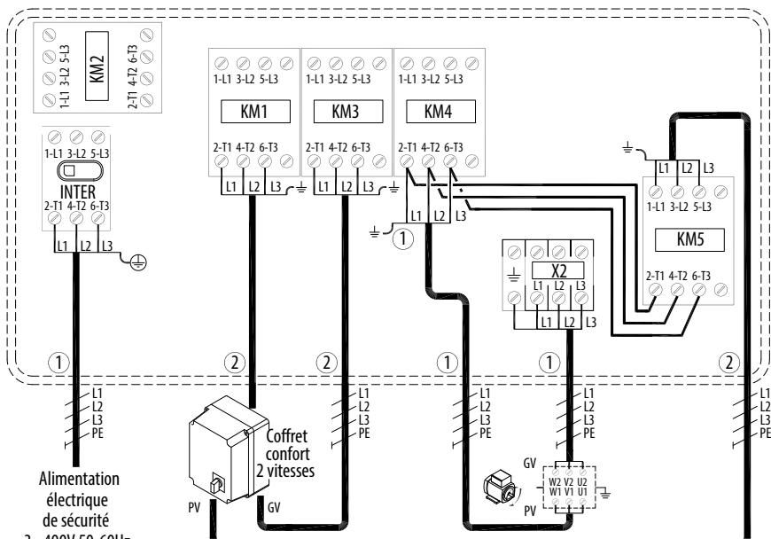
(1) câble protégé au feu ; (2) câble conventionnel Nota : seuls les raccordements à effectuer sont indiqués sur ce schéma. Les autres câblages réalisés d'usine ne sont pas représentés et ne doivent en aucun cas être modifiés.
