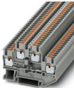
Composant du bloc de jonction, avec diode intégrée 1N4007, type de raccordement: Raccordement Push-in, nombre de connexions: 4, section :0,14 mm<sup>2</sup> - 4 mm<sup>2</sup>, AWG: 26 - 12, largeur: 5,2 mm, hauteur: 45,8 mm, coloris: gris, type de montage: NS 35/7,5, NS 35/15
