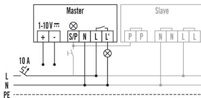
Raccordement maître/esclave avec commande optionnelle par poussoir. Un appareil maître peut être raccordé à 10 appareils esclaves au maximum.
