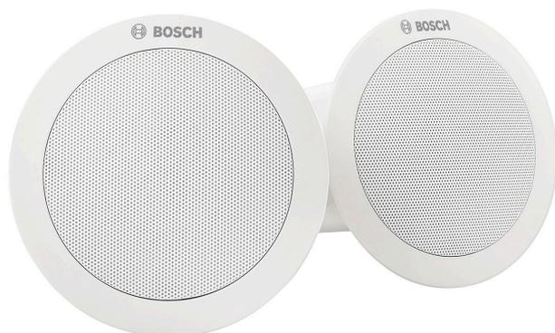
Le modèle LC6-S-L est un haut-parleur d'ambiance 16 ohms de 2 pouces pour montage au plafond, conçu pour être utilisé avec le caisson sub-grave LC6-SW100-L. Le LC6-S-L permet de se connecter facilement à l'unité via un connecteur de type phoenix amovible et s'installe aisément dans de nombreux types de plafond à l'aide de pattes de fixation imperdables.
