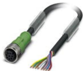
Câbles pour capteurs/actionneurs, 8-pôles, PUR exempt d'halogène, gris-noir RAL 7021, extrémité libre, sur Connecteur femelle droite M12, détrompage A, Longueur du câble: 10 m
