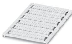
Repères pour blocs de jonction, à commander : sous forme de planche, blanc, impression selon les indications du client, type de montage: encliquetage dans la rainure de repérage élevée, pour bloc de jonction au pas de : 3,5 mm, surface utile: 2,95 x 10,5 mm, Nombre d'étiquettes: 102
