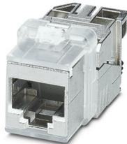
Isolant femelle RJ45, type: RJ45, indice de protection: IP20, nombre de pôles: 8, 10 Gbit/s, CAT6<sub>A</sub>, matériau: Métal, type de raccordement: Raccordement IDC, section raccordable: AWG 26- 22, sortie du câble: droit, Exécution keystone uniquement utilisable avec un cadre IP20 ou une intégration directe sur la paroi du boîtier, Ethernet
