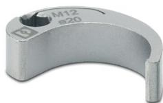
Embout enfichable pour le montage de connecteurs M12 à équiper avec diamètre d'écrou moleté transversal 20 mm, pour emmanchement à six pans de 4 mm
