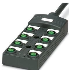
Répartiteur pour capteurs/actionneurs, type de raccordement: Connecteur femelle M12 SPEEDCONNEC, nombre de prises: 8, nombre de pôles: 5, détrompage: A, affectation des prises: double, affichage d'état: Oui, npn; racc. câble multicond.: Connexion fixe 180°, PUR/PVC, longueur du câble: 5 m, blindage: non
