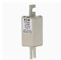
**Cartouche fusible, grande vitesse, 125 A, AC 1000 V, compact size 1, 45 x 45 x 140 mm, aR, DIN, IEC, indicateur de fusion simple**
