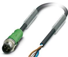
Câble pour capteurs/actionneurs, 4-pôles exempt d'halogène, connecteur mâle droit M12, détrompage: A SPEEDCONNEC, sur extrémité libre, longueur de câble: 9 m
