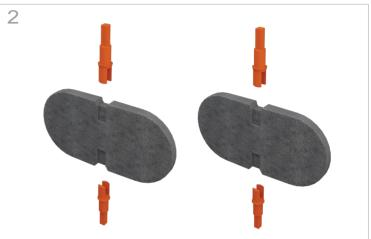
Commencez d'abord par insérer les axes en haut et en bas de chacun des 2 volets NEOPOR®. Nous recommandons d'exercer une légère pression sur les pinces pour un meilleur maintien sur le volet
