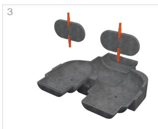
Insérez les volets dans les fentes de la partie basse du plénum répartiteur
