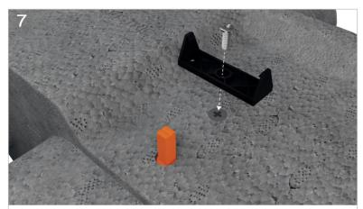
Dans le cas d'un volet motorisé (servomoteur non fourni), vissez la cheville nylon fournie avec chaque servomoteur, puis vissez la pince anti-rotation
