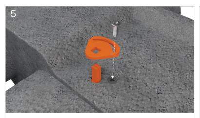
Dans le cas d'un volet manuel, vissez la/les cheville(s) nylon fournie(s) puis insérer le palier de guidage manuel et enfin la vis de serrage vous permettant de définir le débit nominal.
