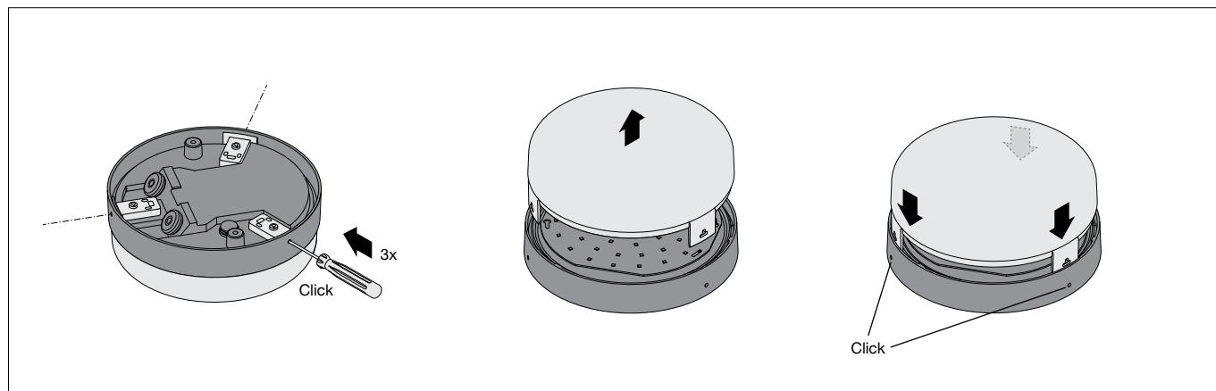
Die Kunststoffabdeckung ist über 3 Federverschlüsse auf dem Leuchtenunterteil befestigt.
