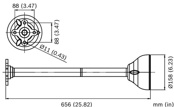
**VDA-CMT-DOME - Support de montage en angle**
