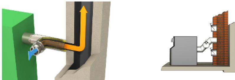
L'installation d'un conduit en acier inoxydable à l'intérieur de la cheminée existante et le montage d'un régulateur de tirage est la solution la plus performante :
