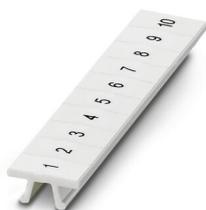
Ruban de repérage ZB, Rubans, blanc, repéré, impression longitudinale: numérotation continue 1 ... 10, 11 ... 20, etc. jusqu'à 491 ... 500, type de montage: encliquetage, pour bloc de jonction au pas de : 5,2 mm, surface utile: 5,15 x 10,5 mm, Nombre d'étiquettes: 10
