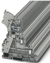
Bloc de jonction-fusibles, type de fusible: Verre / Céramique / ..., type de fusible: G / 5 x 20, tension nominale: 250 V, intensité nominale: 30 A, type de raccordement: Raccordement vissé, Section de référence: 4 mm<sup>2</sup>, section : 0,14 mm<sup>2</sup>- 6 mm<sup>2</sup>, type de raccordement: Raccordement vissé, Section de référence: 1 mm<sup>2</sup>, section : 0,14 mm<sup>2</sup>- 6 mm<sup>2</sup>, type de montage: NS 35/7,5, NS 35/15, coloris: gris
