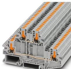
Bloc de jonction à deux étages, tension nominale: 800 V, intensité nominale: 22 A, type de raccordement: Raccordement Push-in, 1er et 2e étage, Section de référence: 2,5 mm<sup>2</sup>, section : 0,14 mm<sup>2</sup> - 4 mm<sup>2</sup>, type de montage: NS 35/7,5, NS 35/15, coloris: gris
