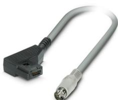
Câble de données servant à la communication, par ex. entre des contrôleurs Phoenix Inline de type ILC 1xx et des appareils Phoenix Contact équipés du port de données IFS 12 pôles, comme QUINT UPS-IQ USV ou TRIO UPS
