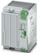
Alimentation secourue avec technologie IQ et accumulateur d'énergie intégré pour montage sur profilé, entrée : 24 V DC, sortie : 24 V DC / 10 A, accumulateur d'énergie : plomb AGM 4 Ah, adaptateur de profilé universel UTA 107/30 monté inclus
