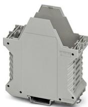
Boîtier électronique sur rail DIN, Partie inférieure du boîtier avec pied métallique de verrouillage, design élancé, sans fente d'aération, largeur: 45,2 mm, hauteur: 99 mm, profondeur: 107,3 mm, coloris: gris clair (7035), connexion transversale: sans connecteur de bus, nombre de pôles connecteur transversal: sans objet
