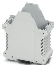
Boîtier électronique sur rail DIN, Partie inférieure du boîtier avec pied métallique de verrouillage, design élancé, avec fentes d'aération, largeur: 45,2 mm, hauteur: 99 mm, profondeur: 107,3 mm, coloris: gris clair (7035), connexion transversale: sans connecteur de bus, nombre de pôles connecteur transversal: sans objet
