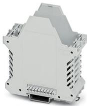
Boîtier électronique sur rail DIN, Partie inférieure du boîtier avec pied métallique de verrouillage, 2 contacts FE, design élancé, avec fentes d'aération, largeur: 45,2 mm, hauteur: 99 mm, profondeur: 107,3 mm, coloris: gris clair (7035), connexion transversale: connecteur de bus intégré, nombre de pôles connecteur transversal: 10, Connecteur de bus : 10 contacts parallèles
