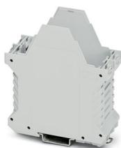
Boîtier électronique sur rail DIN, Partie inférieure du boîtier avec pied métallique de verrouillage, avec contact FE, design élancé, sans fente d'aération, largeur: 45,2 mm, hauteur: 99 mm, profondeur: 107,3 mm, coloris: gris clair (7035), connexion transversale: sans connecteur de bus, nombre de pôles connecteur transversal: sans objet
