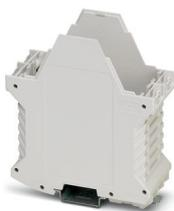
Boîtier électronique sur rail DIN, Partie inférieure du boîtier avec pied métallique de verrouillage, avec contact FE, design élancé, avec fentes d'aération, largeur: 45,2 mm, hauteur: 99 mm, profondeur: 107,3 mm, coloris: gris clair (7035), connexion transversale: Connecteur de bus sur rail DIN (en option), nombre de pôles connecteur transversal: 5
