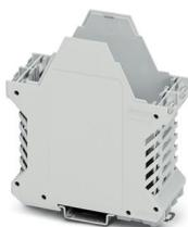
Boîtier électronique sur rail DIN, Partie inférieure du boîtier avec pied métallique de verrouillage, 2 contacts FE, design élancé, avec fentes d'aération, largeur: 45,2 mm, hauteur: 99 mm, profondeur: 107,3 mm, coloris: gris clair (7035), connexion transversale: sans connecteur de bus, nombre de pôles connecteur transversal: sans objet
