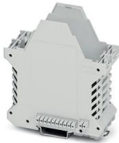
Boîtier électronique sur rail DIN, Partie inférieure du boîtier avec pied métallique de verrouillage, 2 contacts FE, design élancé, avec fentes d'aération, largeur: 45,2 mm, hauteur: 99 mm, profondeur: 107,3 mm, coloris: gris clair (7035), connexion transversale: connecteur de bus intégré, nombre de pôles connecteur transversal: 10+2, Connecteur de bus : 10 contacts parallèles, 2 contacts série
