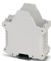
Boîtier électronique sur rail DIN, Partie inférieure du boîtier avec pied métallique de verrouillage, design élancé, sans fente d'aération, largeur: 45,2 mm, hauteur: 99 mm, profondeur: 107,3 mm, coloris: gris clair (7035), connexion transversale: Connecteur de bus sur rail DIN (en option), nombre de pôles connecteur transversal: 5
