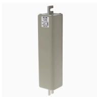
**Cartouche fusible, grande vitesse, 250 A, AC 3.6 kV, 100 kA, special DIN 3, aR, DIN, indicateur visuel**
