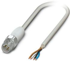
Câble pour capteurs/actionneurs, 4-pôles exempt d'halogène, blindé, connecteur mâle droit M12, détrompage: A, câblé avec déconnecté, sur extrémité libre, longueur de câble: 1,5 m, Conception hygiénique, avec molette inox
