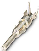
Contact à sertir, Mâle, roulés, Contact unique, diamètre de contact: 1 mm, zone de sertissage: 0,08 mm<sup>2</sup> ... 0,22 mm<sup>2</sup>, Contact individuel
