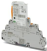
Parafoudre basse tension consistant en une fiche de protection et un élément de base, avec indicateur d'état intégré et sectionnement par couteau pour trois fils de signaux à potentiel de référence commun. Pour applications HF et interfaces de télécommunication sans tension d'alimentation. Mise à la terre indirecte par éclateur à gaz, homologation EX e pour zone 2.
