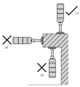
Choisissez pour l'installation une surface plate suffisamment résistante et présentant peu de vibrations. Montez ce produit conformément à la figure pour conserver les caractéristiques IP.
