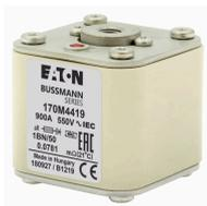
**Cartouche fusible, grande vitesse, 900 A, AC 550 V, 200 kA, size 1, 53 x 69 x 51 mm, aR, IEC, UL, indicateur de fusion simple**
