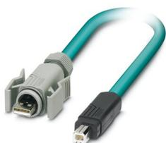
Câble préconfectionné USB, blindé, coloris : RAL 5021 (bleu lagon), gaine extérieure PUR, USB type A/IP67 sur USB type B/standard, longueur : 2 m
