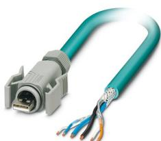
Câble préconfectionné USB, blindé, coloris : RAL 5021 (bleu lagon), gaine extérieure PUR, USB type A/IP67 sur extrémité non terminée, longueur : 1 m
