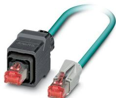
Câble Ethernet préconfectionné, CAT5e, blindé, 2 paires, AWG 26 souple (7 fils), RAL 5021 (bleu lagon), connecteur mâle RJ45/IP67 boîtier plastique Push-Pull sur connecteur mâle RJ45/IP20, Line, longueur 5 m
