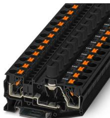
Bloc de jonction-fusibles, type de fusible: Verre / Céramique / ..., type de fusible: G / 6,3 x 32, tension nominale: 1000 V, intensité nominale: 10 A, type de raccordement: Raccordement Push-in, Section de référence: 6 mm<sup>2</sup>, section : 0,5 mm<sup>2</sup>- 10 mm<sup>2</sup>, type de montage: NS 35/7,5, NS 35/15, coloris: noir
