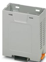
Boîtier électronique sur rail DIN, Partie inférieure du boîtier avec base encliquetable, design élancé, avec fentes d'aération, largeur: 35,1 mm, hauteur: 75 mm, profondeur: 87,3 mm, coloris: gris clair (7035)
