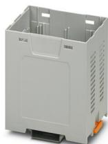
Boîtier électronique sur rail DIN, Partie inférieure du boîtier avec base encliquetable, design élancé, avec fentes d'aération, largeur: 52,6 mm, hauteur: 75 mm, profondeur: 87,3 mm, coloris: gris clair (7035)
