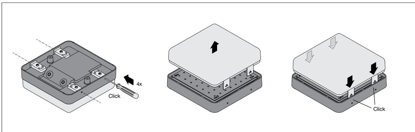
Die Kunststoffabdeckung ist über 4 Feder-verschlüsse auf dem Leuchtenunterteil befestigt.
