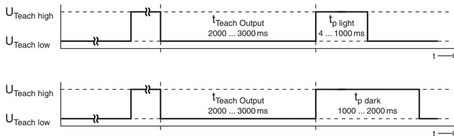
Après écoulement du temps d'initialisation ( $\leq 300\text{ms}$ ), la touche d'apprentissage est utilisable sur l'appareil.
