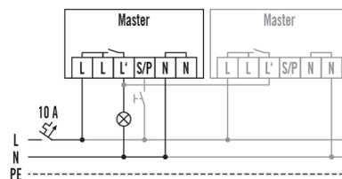
Raccordement standard avec commande en option par bouton-poussoir de fermeture et raccordement en parallèle de 5 appareils au maximum
