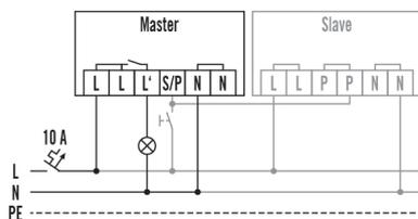
Raccordement standard avec commande en option par bouton-poussoir et utilisation de 6 appareils esclaves maximum sur un appareil maître.
