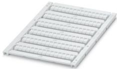
Repères pour blocs de jonction, Plaque, blanc, vierge, repérable avec : TOPMARK NEO, LASER TOPMARK, BLUEMARK ID COLOR, BLUEMARK ID, BLUEMARK CLED, THERMOMARK PRIME, THERMOMARK CARD 2.0, THERMOMARK CARD, type de montage: encliquetage, pour bloc de jonction au pas de : 4,2 mm, surface utile: 3,4 x 4,7 mm, Nombre d'étiquettes: 90
