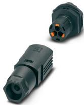
Traversée de paroi, Raccordement Push-in, nombre de pôles: 2+PE, 600 V, 20 A, noir, diamètre extérieur du câble: 6 mm ... 9 mm et 8 mm ... 13 mm, filetage de montage: M25, Raccordement Push-in
